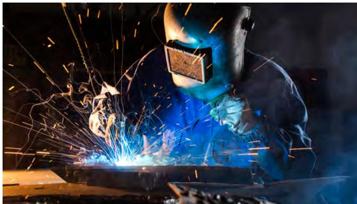
La soldadura y el corte son métodos para conectar o cortar objetos metálicos que utilizan el calor extremo producido por corriente eléctrica o gases comprimidos. Los peligros más comunes asociados con la soldadura y el corte en la industria de muros y techos son descargas eléctricas (soldadura por arco eléctrico), peligros respiratorios, lesiones oculares e incendios.
