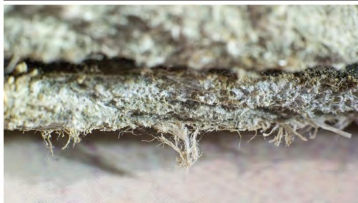
El asbesto es un mineral fibroso de silicato resistente al calor que se utiliza en materiales de construcción resistentes al fuego y en aislantes. Puede ser dañino para los trabajadores cuando se inhala o se ingiere.
