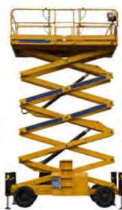
Las plataformas elevadoras son máquinas diseñadas para levantar a los trabajadores para realizar trabajos en áreas elevadas. Entre los ejemplos se incluyen los elevadores de tijera, plataformas con pluma telescópica y plataformas con pluma articulada.
