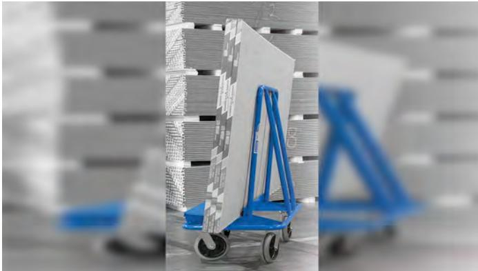
Los carros rodantes para paneles de yeso tienen el potencial de lesionar a los trabajadores y transeúntes en las cercanías del carro. Los carros que no se mantienen correctamente, el uso inadecuado, la carga incorrecta, el descuido y los juegos bruscos
