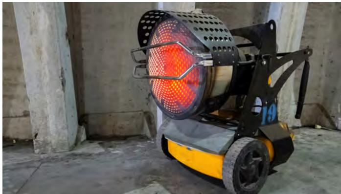
El equipo de calefacción para uso temporal se refiere a los calentadores que se usan en los lugares de trabajo para calentar áreas donde no se han instalado sistemas de calefacción permanentes. Estos calentadores temporales suelen funcionar con circuitos de 110 voltios, baterías o algún tipo de combustible para calefacción, como el propano.
